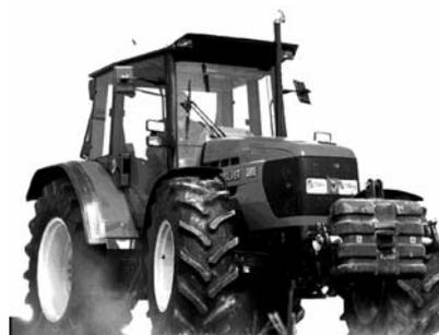
ZUGLEISTUNG: max. Leistung 56,6 kW bei 11,4 km/h und Motordrehzahl 2362 min<sup>-1</sup>, dabei 300 g/kWh, bei Nenndrehzahl nicht gemessen
