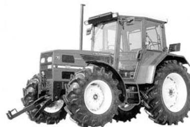
**ZUGLEISTUNG:** bei Nenn Drehzahl 38,4 kW bei 9,3 km/h, dabei 302 g/kWh
